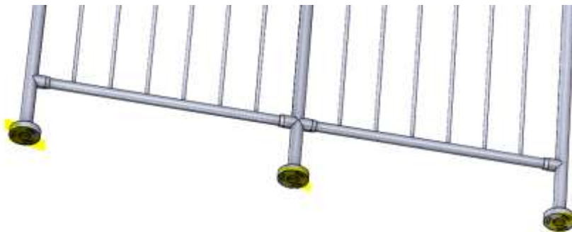
Geschweißte Ronde am Boden
