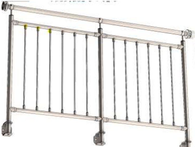
Geschweißte Ronde am Boden
