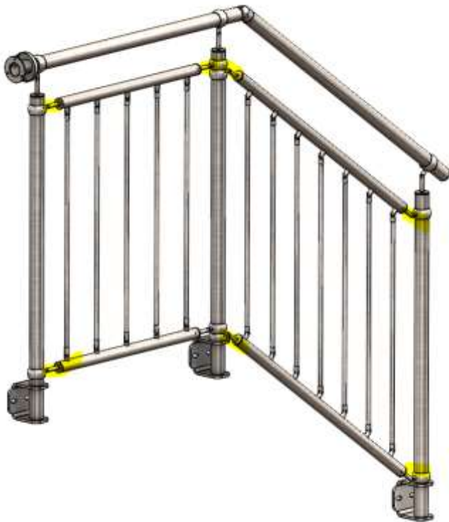
Trägerplatten am Handlauf
