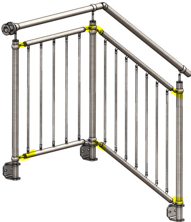
Trägerplatten am Handlauf
