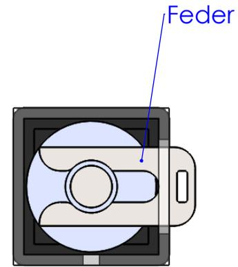
Hier die Federn in die Schlitz einführen bis sie einrasten
